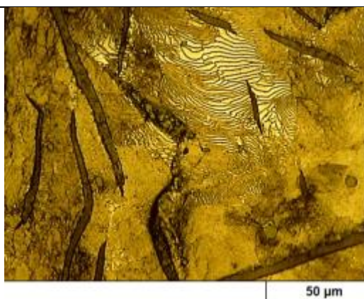
ساختار تماماً پرلیتی در یک نمونه چدن خاکستری
