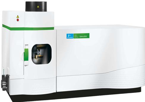
این روش بر مبنای استفاده از پلاسما به عنوان منبع تهییج جهت آنالیز کمی و کیفی عناصر می باشد. در این روش جریانی از گاز آرگون توسط یک میدان مغناطیسی با فرکانس رادیویی ۲۷-۴۰ MHz یونیزه می شود و حرارتی نزدیک به ۱۰۰۰۰ درجه کلوین تولید می کند. نمونه توسط یک نبولایزر به داخل پلاسما آرگون پاشیده می شود و در دمای بالا نمونه تبدیل به ذرات اتمی (یونی) می شود و ایجاد نشر می کند. میزان نشر توسط دستگاه اندازه گیری می شود.
