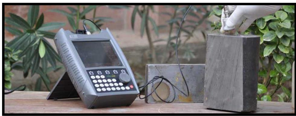
بازه گسترده‌ای از آزمون‌های متالورژیکی به صورت پرتابل قابل ارائه در محل می‌باشند از جمله متالوگرافی، تهیه رپلیکا، سختی سنجی، آنالیز شیمیایی، اندازه‌گیری ضخامت و میزان چسبندگی پوشش‌ها به صورت پرتابل قابل ارائه در محل می‌باشند.
