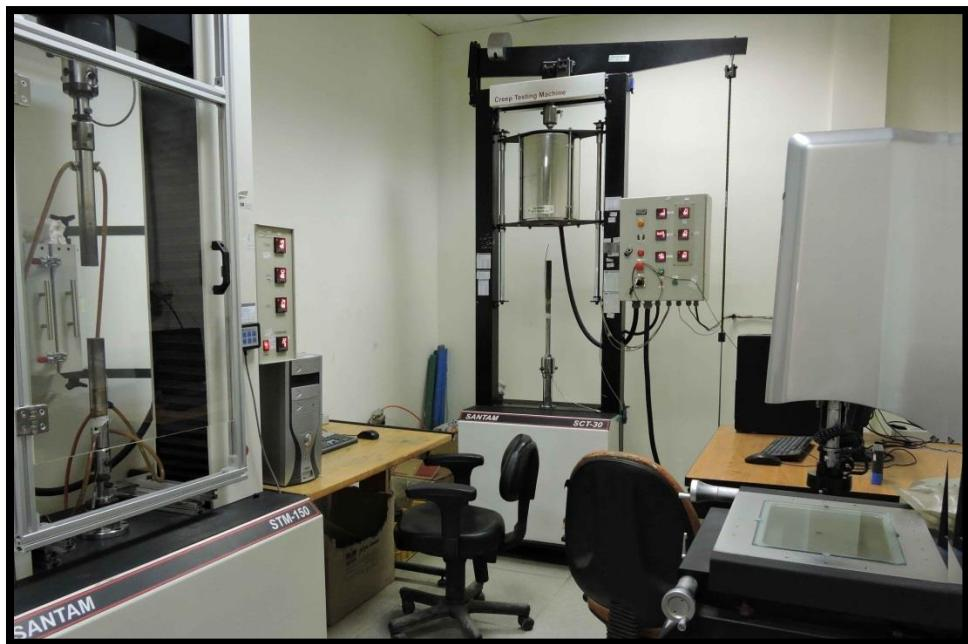
با استفاده از طیف گسترده‌ای از تجهیزات اندازه‌گیری خواص مکانیکی مانند دستگاه کشش، سختی، خستگی، خزش، کشش گرم، ضربه و خمش امکان انجام اغلب آزمون‌های اندازه‌گیری خواص مکانیکی مواد در این آزمایشگاه وجود دارد.
