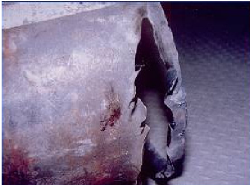
شکل ۱- قطعه مورد استفاده در صنایع هسته ای که توسط فرایند FAC تخریب شده است.
