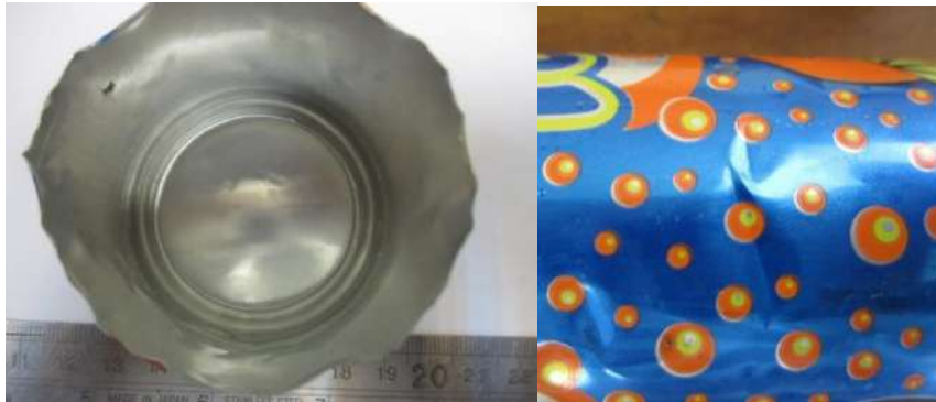
شکل ۴- آثار آسیب مکانیکی روی بدنه (سمت راست)- محصولات خوردگی در سطح داخلی (سمت چپ)
