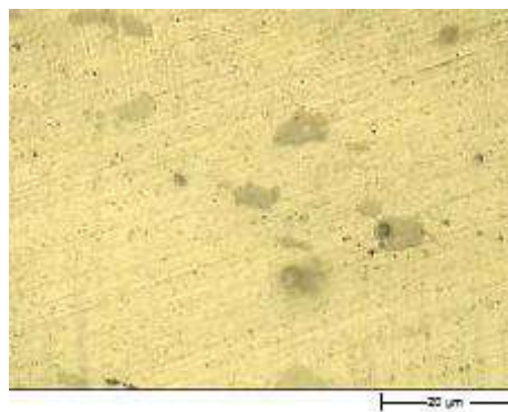
شکل ۸- تصویر میکروسکوپ نوری از وجود ترکیبات بین فلزی در زمینه محلول جامد آلومینیوم
