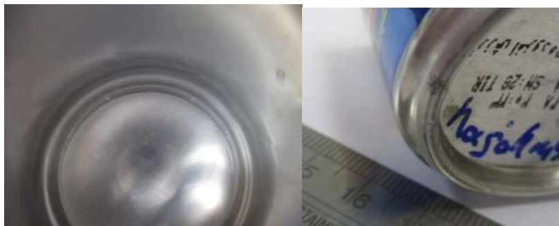
شکل ۵- مشاهده محصولات خوردگی در سطوح خارجی (سمت راست) و سالم بودن سطوح داخلی (سمت چپ)
