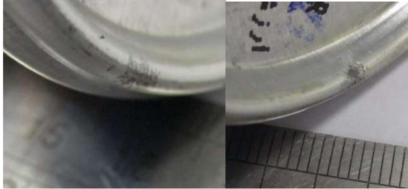
شکل ۳- تصویر سوراخ ایجاد شده ناشی از خوردگی (سمت راست)- محصولات خوردگی روی لبه کف قوطی (سمت چپ)
